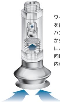
ワークが真空パッドの一部を覆っていない場合またはハンドリングの途中でパッドから離れる場合。エアフローによってボールがシート方向に押し上げられ、システム内の真空圧を維持します。
