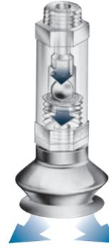
ワークがリリースされた状態。ボールがシートから押し戻されてバルブの断面積が広くなり、大流量のエアが排出され、ワークは確実に素早くリリースされます。
