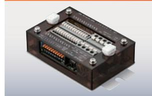
多数のセンサー入力を基板内でAND化し、一出力としてロボットに出力。
