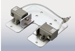
ロボットアームに直接取付け、ミニシリンダーにてランナーを取り出し可能です。
